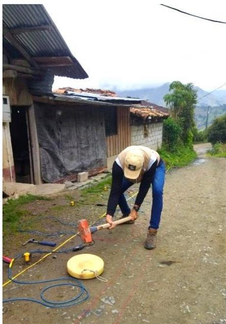
Una vez terminado el sondeo, se procedió a realizar la extracción de información para poder el análisis mediante el programa REFLEXW, importando los archivos en formato SG2 propios de sondeos sísmicos, para observar el arribo de onda **Figura 2.13**.
