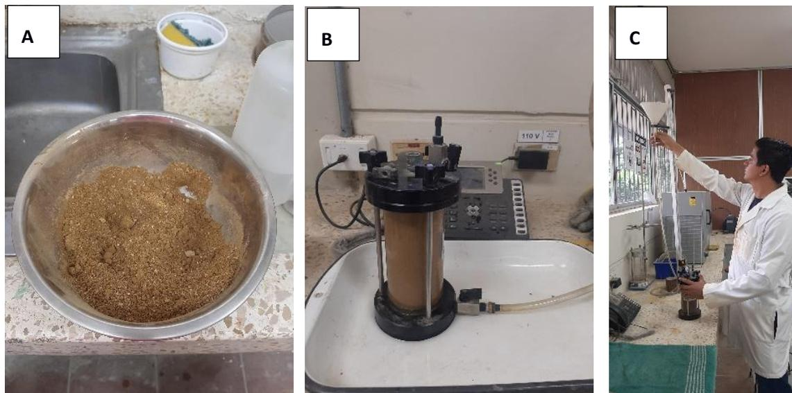
*A) muestra homogenizada con el porcentaje de humedad, B) permeámetro armado, C) ensayo de carga variable*
