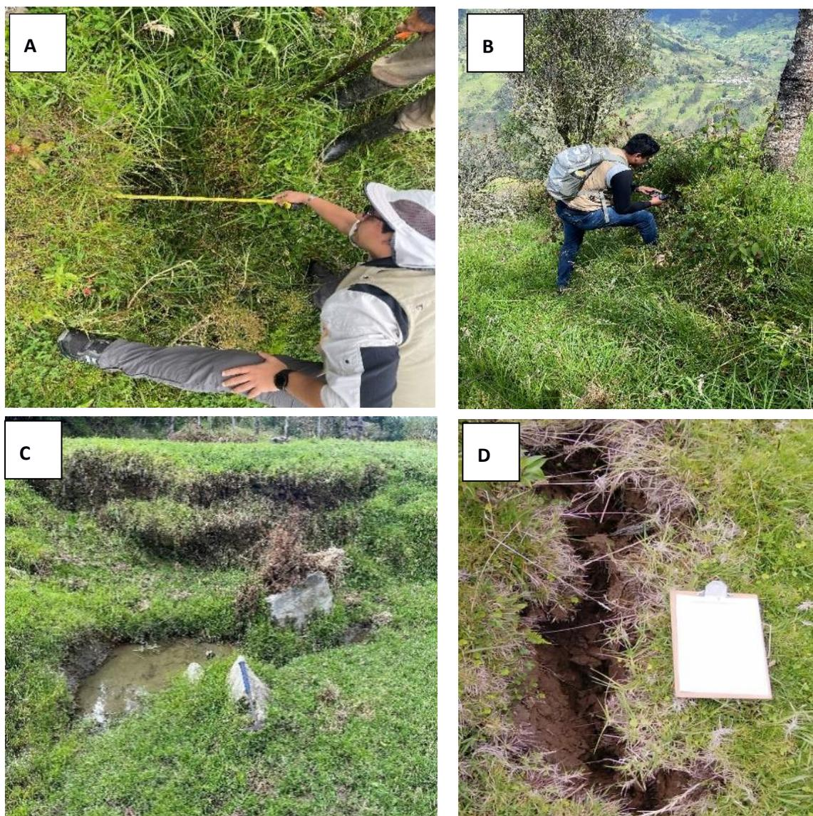
*A) Medición de grietas, B) Toma de dirección de escarpes, C) cuerpo de agua, D) grieta de tracción*
