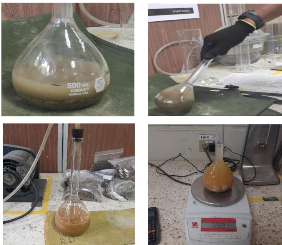
A) colocación de muestra en el matraz, B) homogenización de muestra y agua, C) extracción de aire por bomba de vacíos, D) pesado de muestra final
