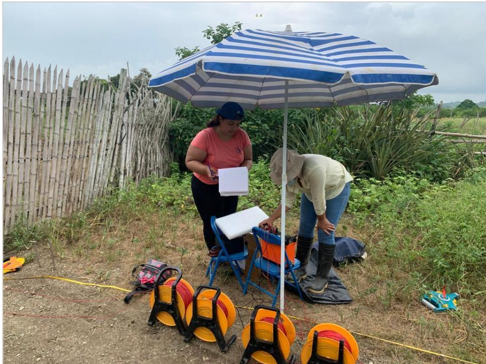
**Figura 2.3 Toma de datos a través del Sondeo Eléctrico Verticales**
