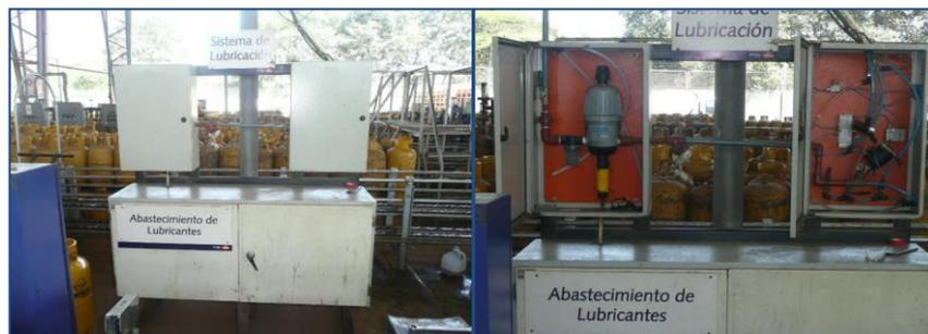
**FIGURA 4.4 NUEVO SISTEMA DE LUBRICACIÓN DE CADENA DEL TRANSPORTADOR**
