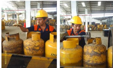
**FIGURA 2.5 VERIFICACIÓN DE SUPERFICIE Y ENDEREZAMIENTO DE ASA**
