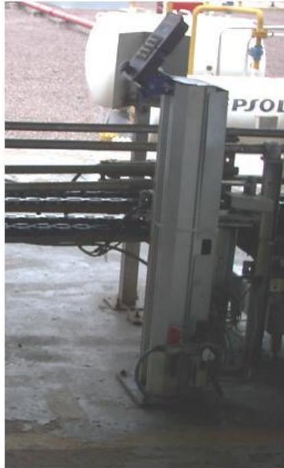
**FIGURA 3.5 TABLERO DE INGRESO DE DATOS DEL PUESTO DE TABULADO**
