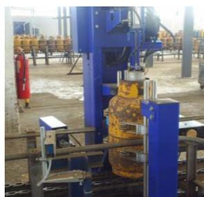
**FIGURA 2.9 VERIFICACIÓN DE FUGA**
