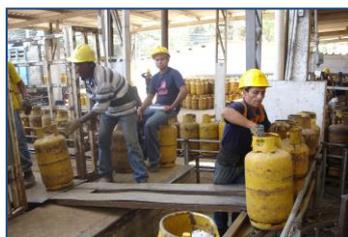
**FIGURA 4.6 OPERACIÓN DE DESCARGA DE CILINDRO -
