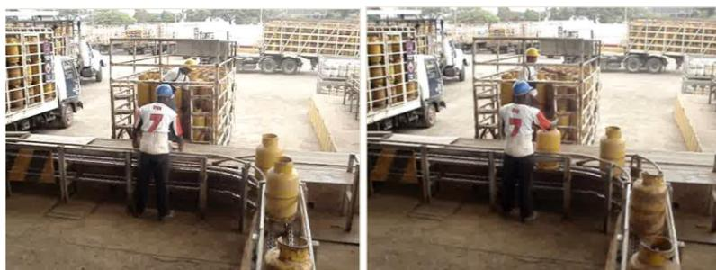
**FIGURA 4.7 OPERACIÓN DE DESCARGA DE CILINDRO -
