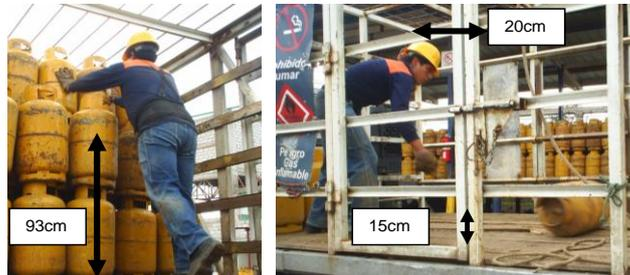
**FIGURA 4.15 FOTO DE OPERACIÓN DE APILAMIENTO DE CILINDRO LLENO**
