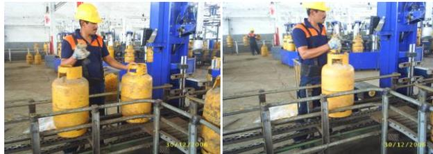
**FIGURA 2.10 COLOCACIÓN DE SELLO DE SEGURIDAD**
