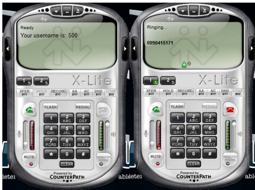
Figura 4.24 Autenticación exitosa en la central “192.168.4.230” y generación de llamadas telefónicas desde la máquina atacante
