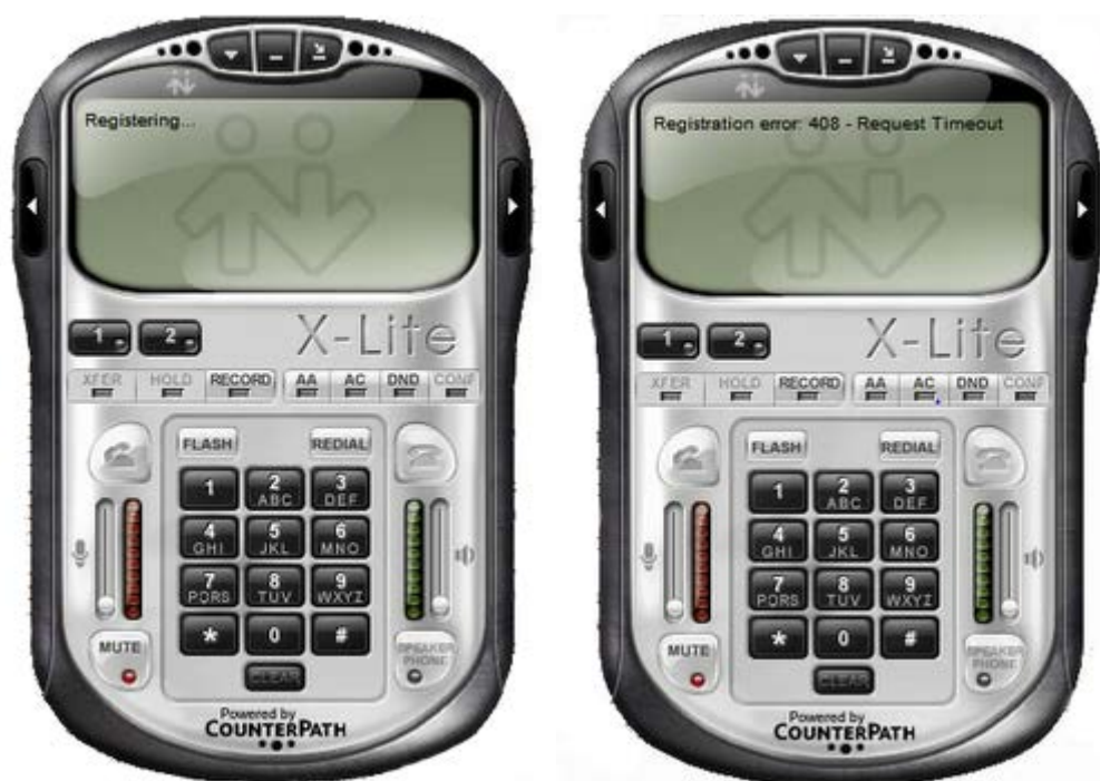
Figura 4.19 Estado de los teléfonos durante el ataque de denegación de servicios
