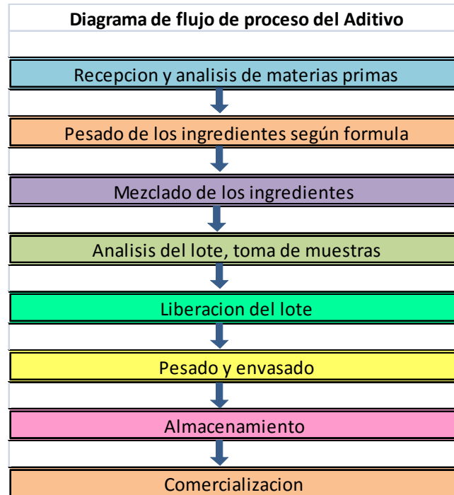
Figura 4.7 Diagrama flujo elaboración aditivo Fuente: C. Benavides, 2011
