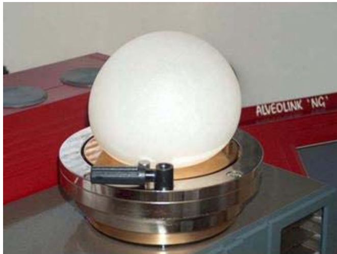
Figura 2.3 Burbuja de Alveógrafo
