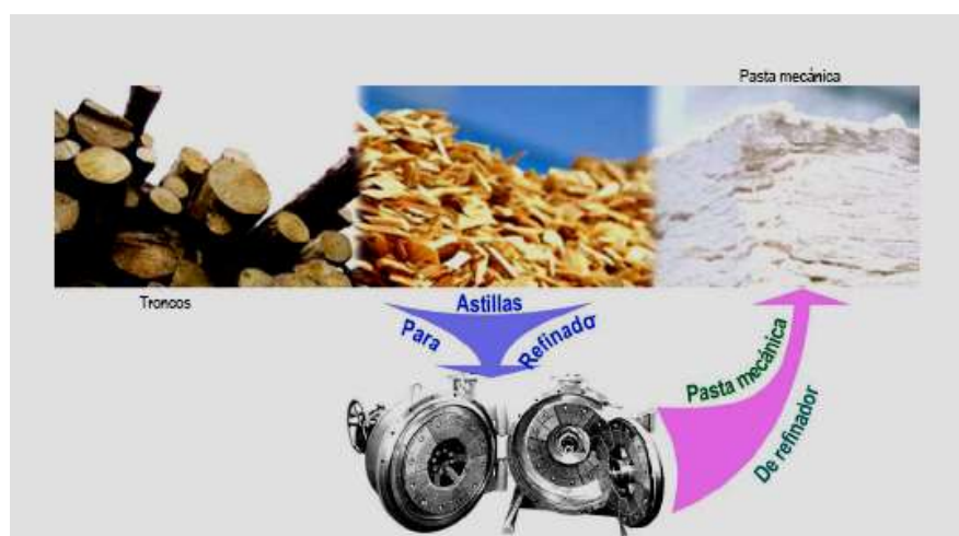
FIGURA 1.8 ELABORACIÓN DE PASTA MECÁNICA POR MEDIO DE REFINADOR
