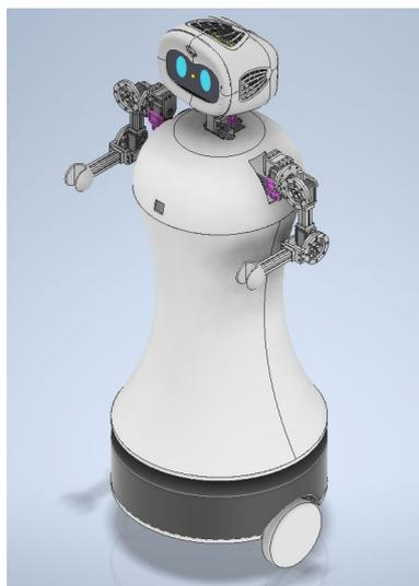
En la figura 3.1 se ilustra el acople del brazo robótico al robot de servicio Walter con el conjunto de estructuras flexibles SEA dentro de cada articulación que contiene, el sistema del brazo se encuentra diseñado con 3 grados de libertad en el software Inventor.
