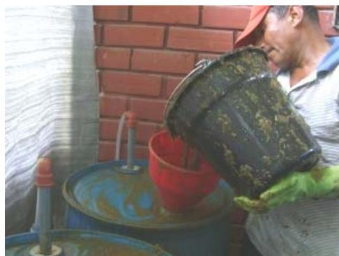
Fotografía 3. Introducción del estiércol fresco en los biodigestores respectivos
