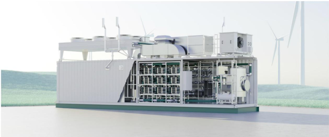
Este electrolizador cuenta con una capacidad de producción de 450 kg de hidrógeno por día, sin embargo, es adaptable a necesidades específicas y se podría aumentar para conseguir los 525kg de hidrógeno requeridos por día. Así mismo, tiene un consumo específico de energía es de 53 kWh/kg de H<sub>2</sub>, con una eficiencia del sistema del 75%, más detalles en la ficha técnica adjunta en anexos, Anexo E.
