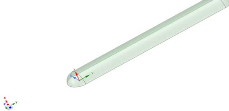
Para los elementos superficiales se colocó el espesor correspondiente al tanque, ese dato se proporcionó en el apartado de propiedades como se muestra en la figura 2.6.
