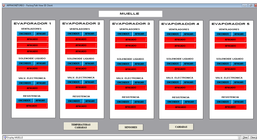
Figura 3.20 HMI del control de evaporadores del muelle
