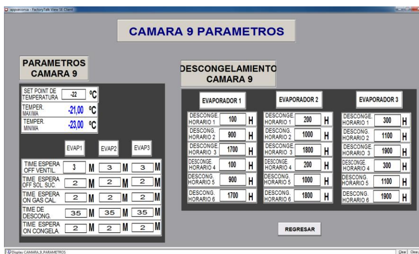
Figura 3.18 HMI de los parámetros de la cámara 9
