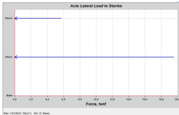
Figura 3.12 Distribución de cortante basal por piso en Sx [ETABS]
