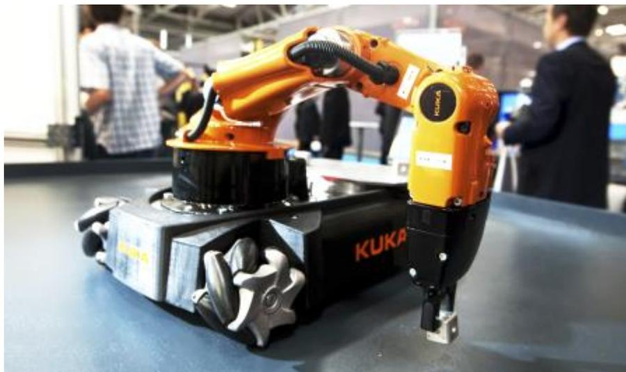
Figura 1.7 Manipulador KUKA *youBot* utilizado para investigación. Utiliza motores *brushless* para generar el movimiento. Compañía KUKA [11]
