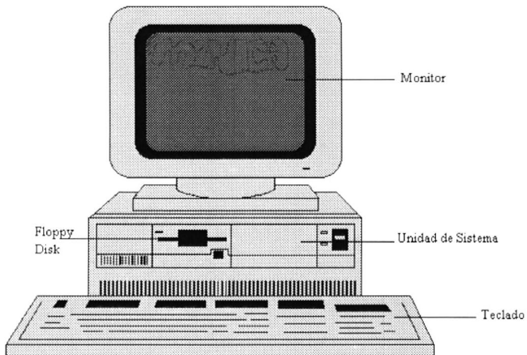
El *hardware* que compone al computador más básico incluye un monitor, un teclado y una unidad de sistema. La unidad de sistema contiene el procesador, la memoria, disketteras, puertos, y tarjeta de video.
