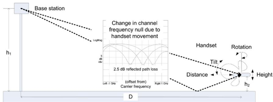
*Nota:* La figura muestra el escenario de una farola que ilustra el problema de un canal de radio con rutas de señal en movimiento. Tomada de [20]
