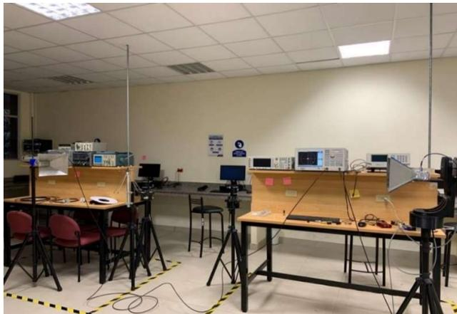
*Nota:* Medición del parámetro S21 con línea de vista en el laboratorio
