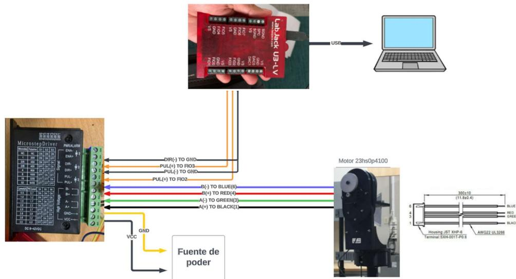
*Nota:* Visualización grafica de las conexiones de los pines entre el LabJack, el driver y el motor
