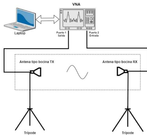
*Nota:* Representación ilustrativa de la conexión de las antenas para realizar la medición.
