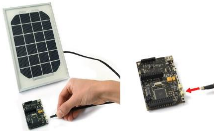
Figura 3.13 Conexión Panel Solar [3]
