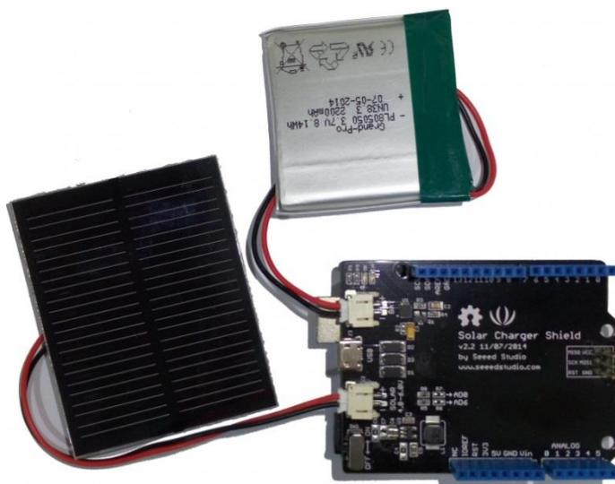
**Figura 4.5: Arduino Solar Charger Shield, batería LIPO y panel solar**
