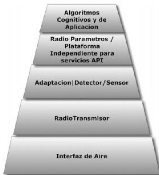
Figura 2.7: Modelo de un Sistema de Radio Cognitiva [23]
