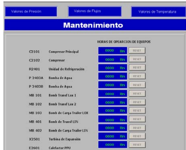
Figura 28-Vista de la pantalla de horas de funcionamiento de equipos
