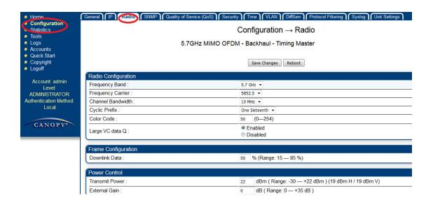
Figura 4.39 Configuración de radio MIMO - OFDM
