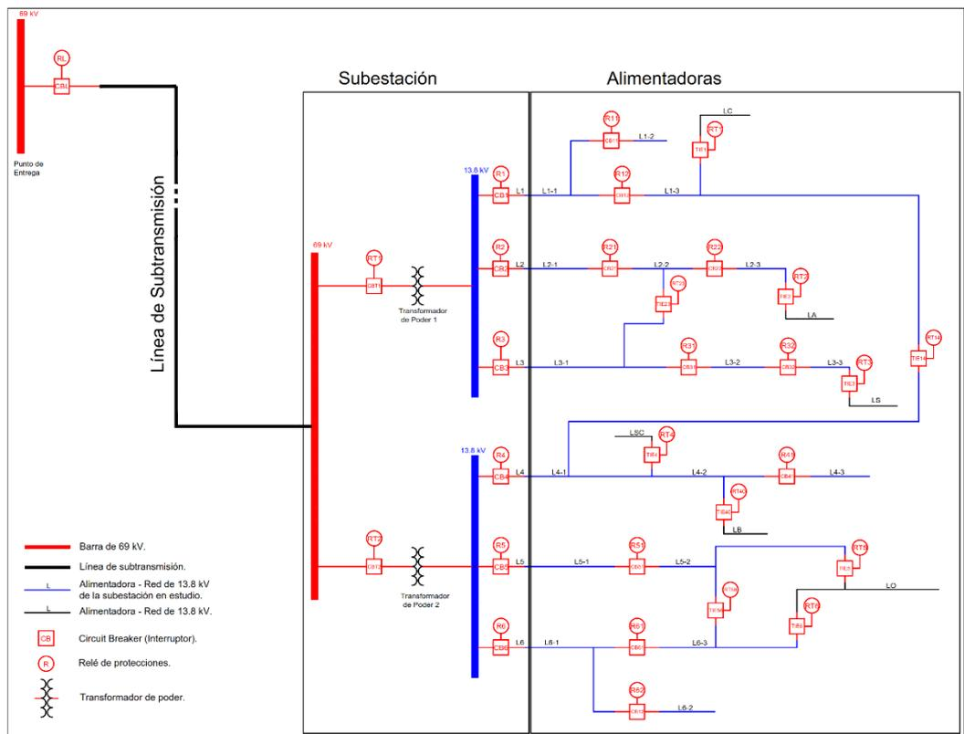
Figura 11.- Unifilar de la subestación con las 6 alimentadoras.
