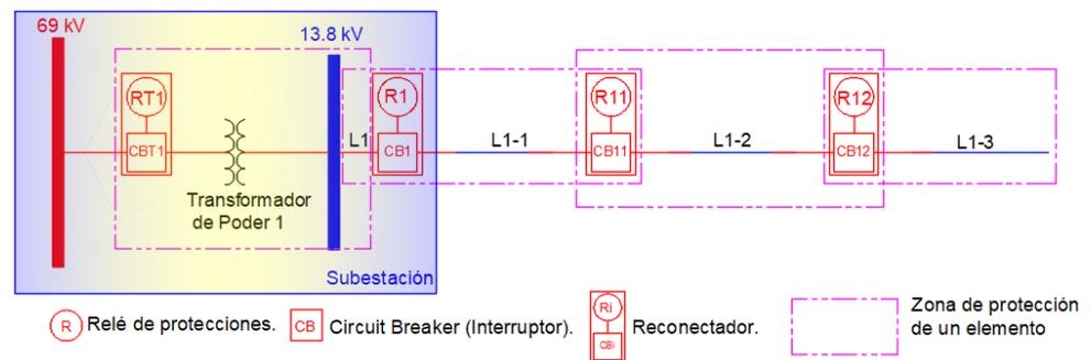
Figura 5.- Protecciones eléctricas por zonas en una alimentadora.
