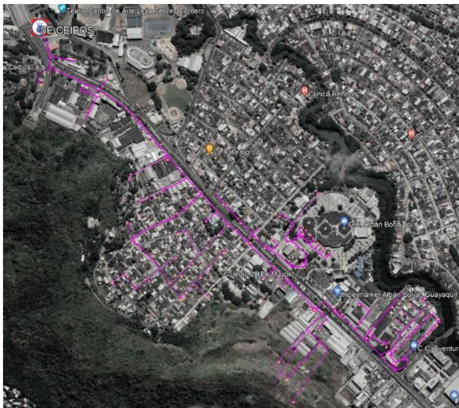
Figura 4.- Recorrido de la alimentadora Carlos Julio que sale del transformador #1 de la Subestación Ceibos.
