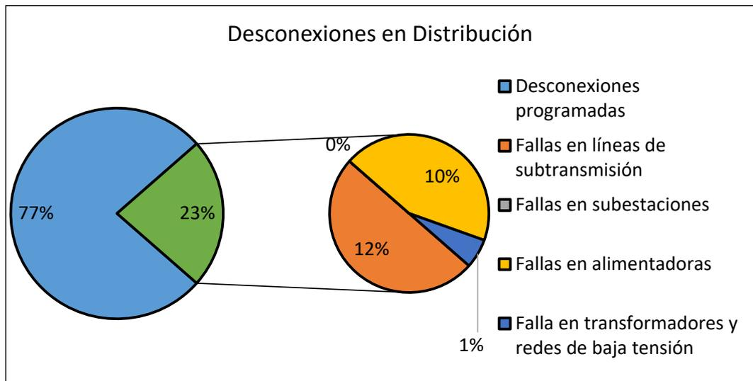
Figura 1.- Desconexiones en el sistema de distribución de Guayaquil.
