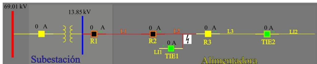
Figura 16.- Falla en L2 y operación errónea del reconector R1.
