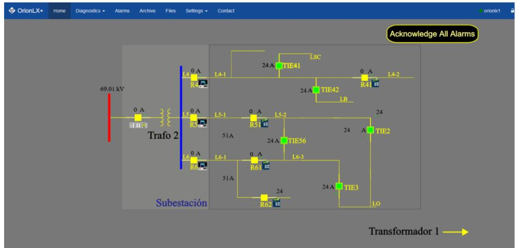
Figura 21.- HMI de las alimentadoras del transformador 2.
