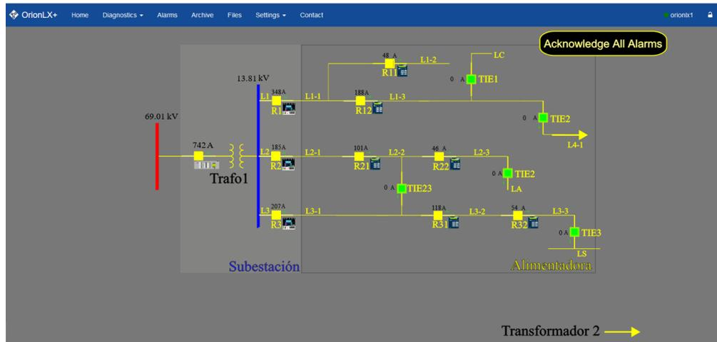
Figura 20.- HMI de las alimentadoras del transformador 1.
