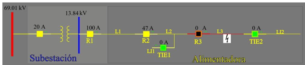
Figura 13.- HMI de la alimentadora con una falla en el tramo L3.
