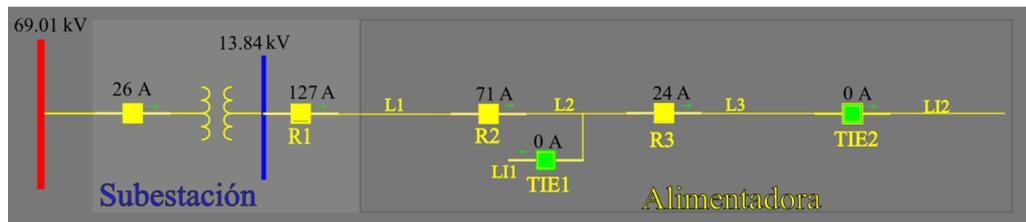
Figura 12.- HMI para una alimentadora en condiciones de operación normal.
