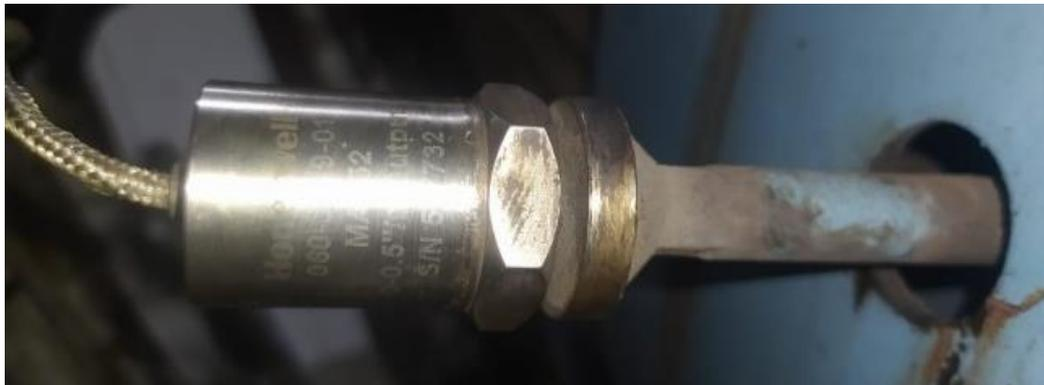
Entre sus funcionalidades se encuentran: la medición de velocidad, rango de frecuencia usable de 2 Hz a 10 kHz, 4 mA a 20 mA proporcional a la velocidad, opción sumergible, con cable blindado de acero inoxidable integral o conector o una opción intrínsecamente segura.
