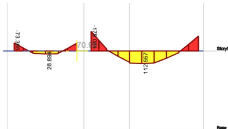
**Figura 3.5 Capacidad de las vigas arriba de la columna de 50x50.**
