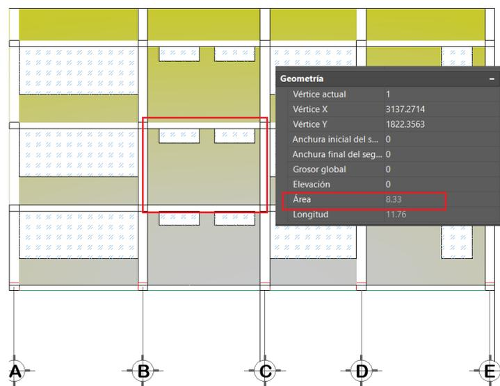
**Figura 5.2 Área representativa de las paredes, vista en elevación.**
