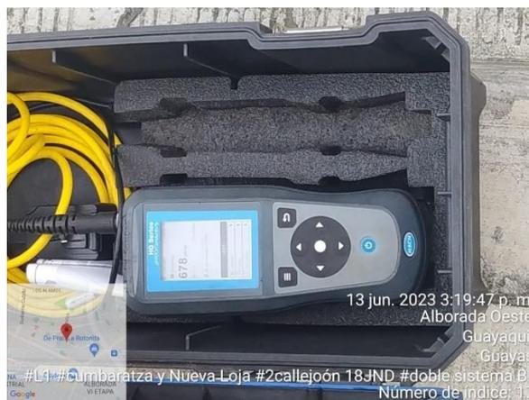
Figura 2.5 Medición de conductividad en multiparamétrica HACH
