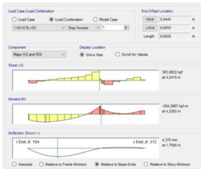
Figura 3.7 Momento actuante en la viga del perfil PGC 254X1.50 [Etabs, 2022]
