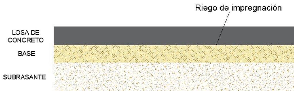
**Figura 2.4 Capas del pavimento rígido**
