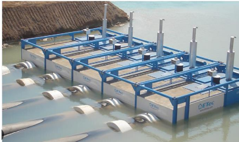
Figura 1.4 Conductos de alimentación y descarga
