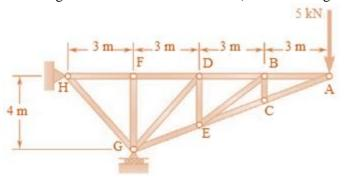
2a) DSL de la armadura completa:
