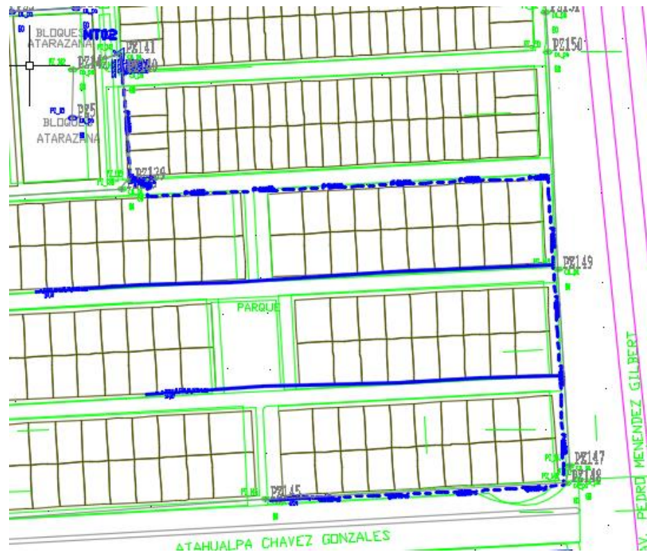
Figura 3.30: Cable de distribución FD08.
