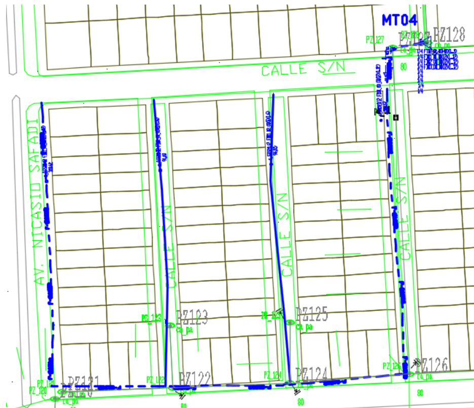
Figura 3.22: Cable de distribución FD01.
