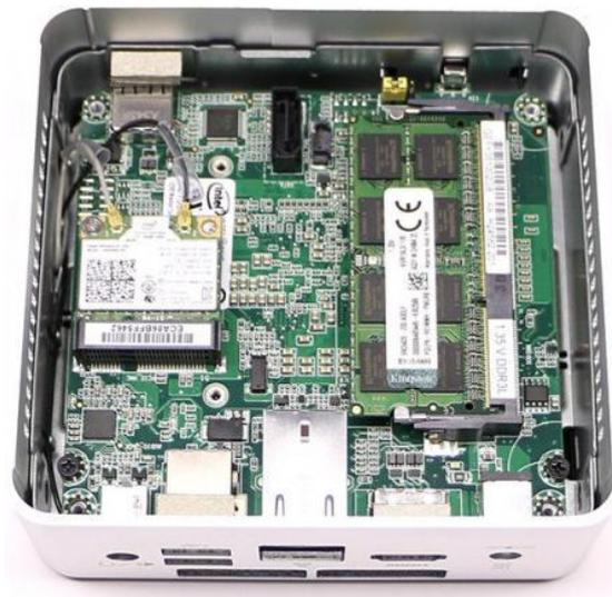
*Figura 4.2 Diagrama de la placa frontal del Nuc Intel Celeron [35]*
