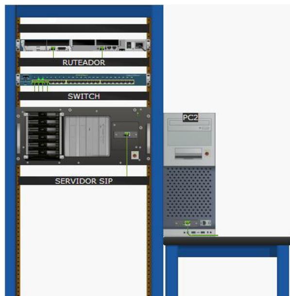
*Figura 4.5 Rack de comunicaciones de la central telefónica IP*
