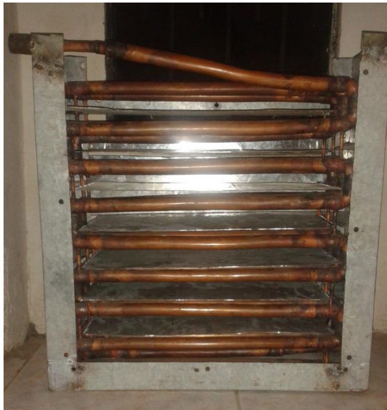
Foto 3. Intercambiador de calor con su carcasa
