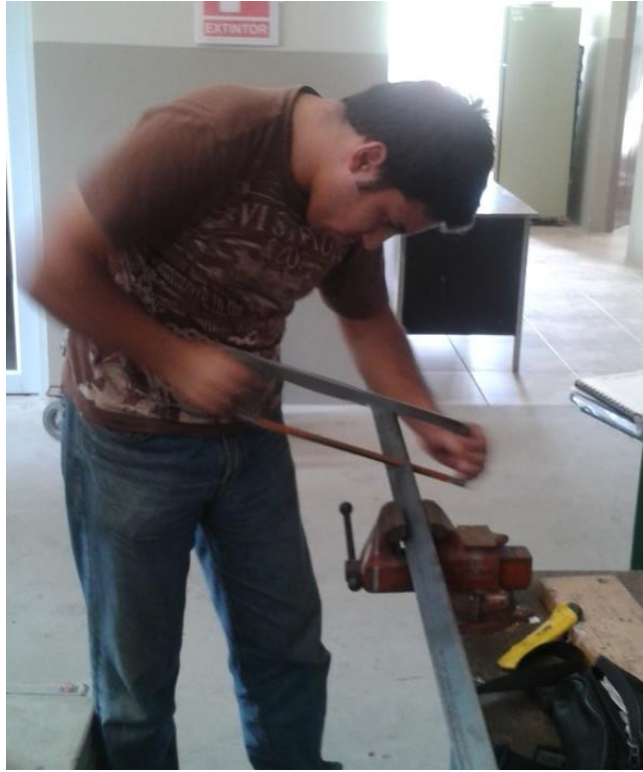
Foto 5. Corte de ángulos para soporte
