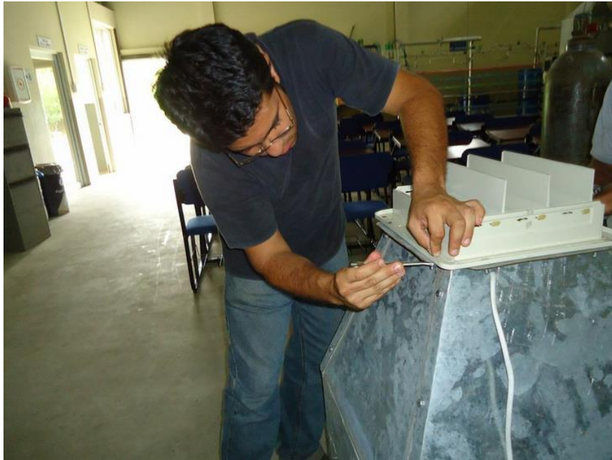
Foto 4. Acople del ventilador a la campana
