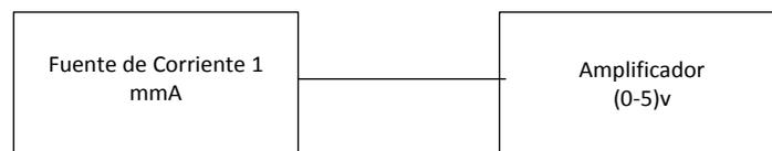
**Figura 3.2 Diagrama de bloques del circuito acondicionador para la PT100**
