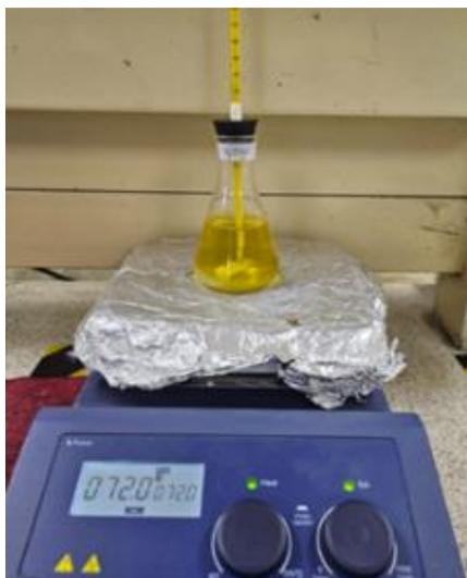
*Nota.* Sistema empleado para llevar a cabo la interesterificación enzimática.
