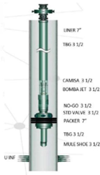
Ilustración 1.3: Completación de fondo / Fuente: Sertecpet
