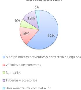
Fig 4: Tiempos de para en MTU'S de combustión
