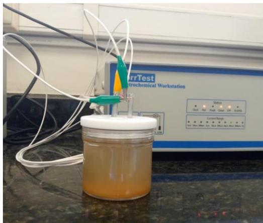
**Figura 2.7. Celda electrolítica usada para experimentación de tratamiento de agua mediante electrocoagulación [Espinoza & Franco, 2022].**
