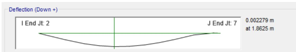
Figura 3.52. Deflexión máxima de la estructura. [Suarez & Salcedo - ETABS, 2023]
