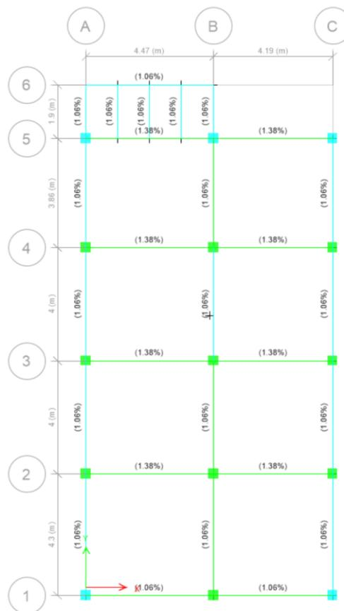
Figura 3.44. Cuantía de acero en vigas del primer piso. [Suarez & Salcedo - ETABS, 2023]
