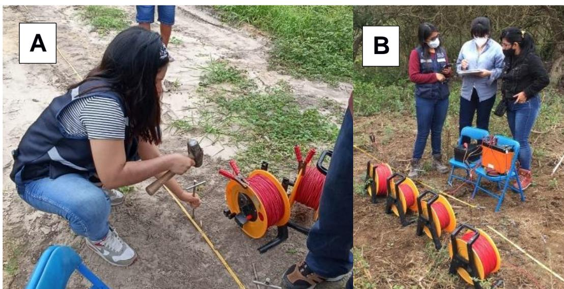
**Figura 3.5 A) Colocación de electrodos. B) Toma de datos del SEV.**
