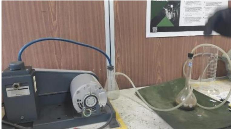
**Figura 3.10. Bomba al vacío conectada al matraz con la muestra.**
