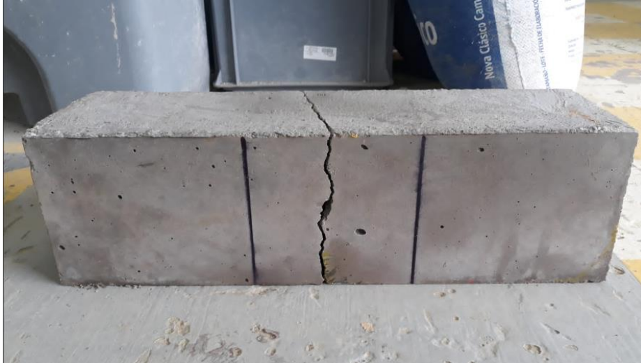
Figura 42 Rotura de viga con fibras metálicas
