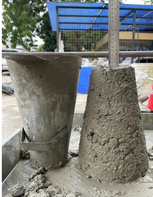
Figura 35 Elaboración del ensayo de asentamiento de mezclas
