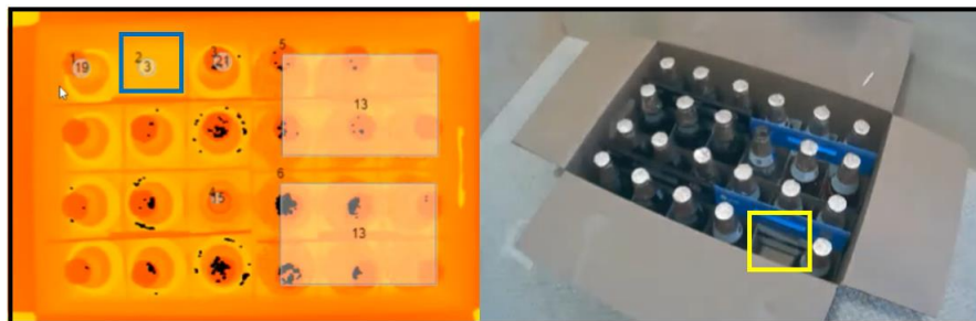
Ilustración 3.1.3 Validación 2: Un envase faltante
