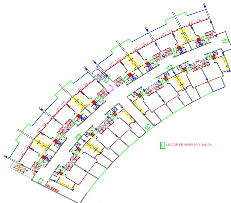
Figura 3.14 Implantación de sensores sexto piso
