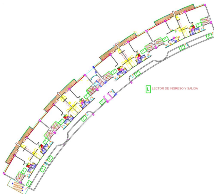
Figura 3.10 Implantación sensores segundo piso
