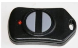
Figura 3.4 Tarjeta de identificación (Tag) [37]
