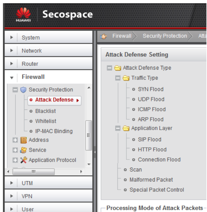
Figura 3.3: Protección de seguridad embebida en el firewall
