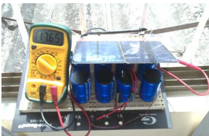
Figura 5.20: Prueba de campo del sistema de alimentación basado en supercapacitores.
