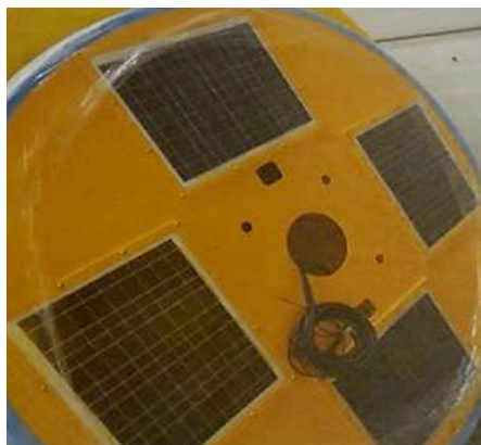
Figura 2.4: Paneles solares de la Boya Tsunámica MESEMAR.
