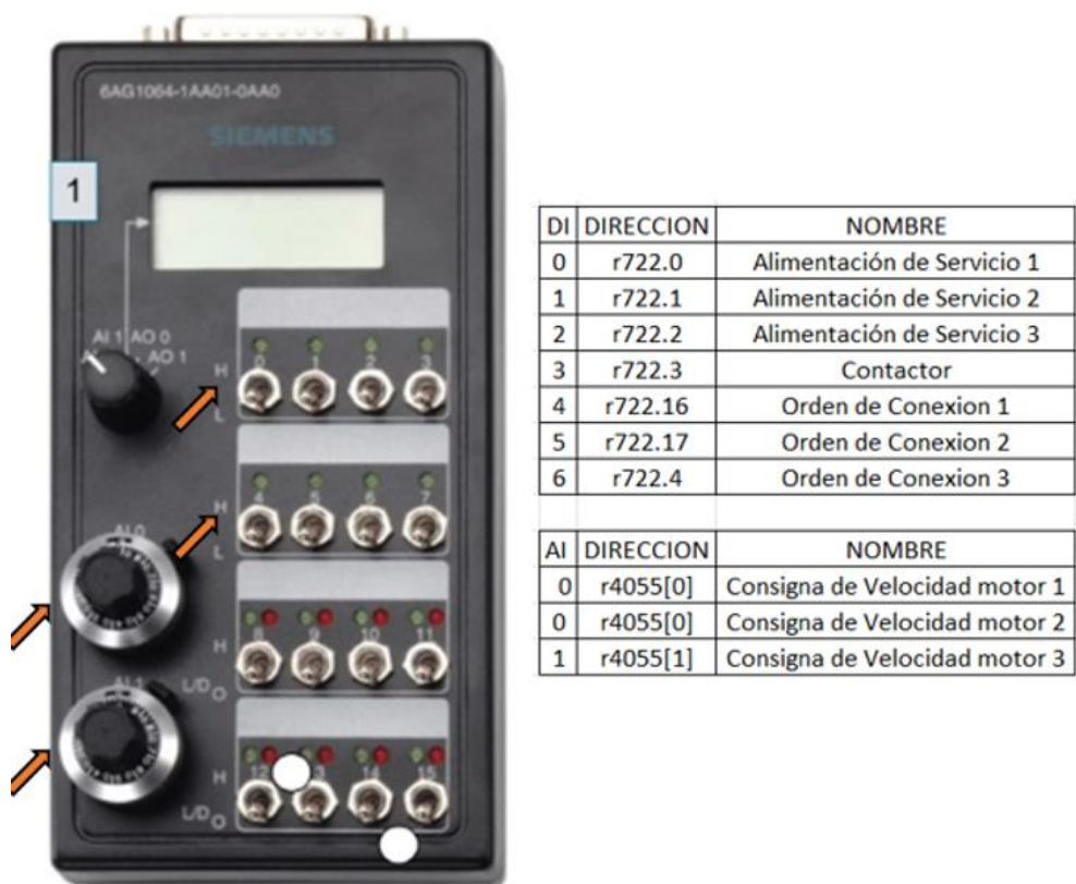
Figura 3.3 Módulo terminal para el control del operador (TB31)
