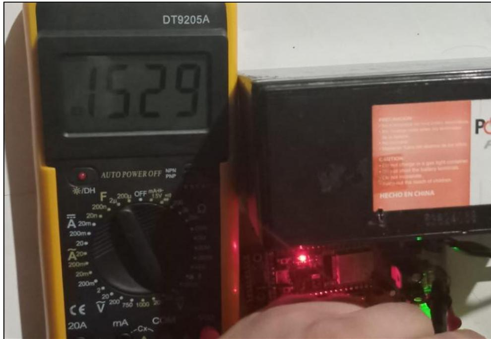
Ilustración 50. Medición de la tensión de entrada proporcionada por la fuente de alimentación principal.
