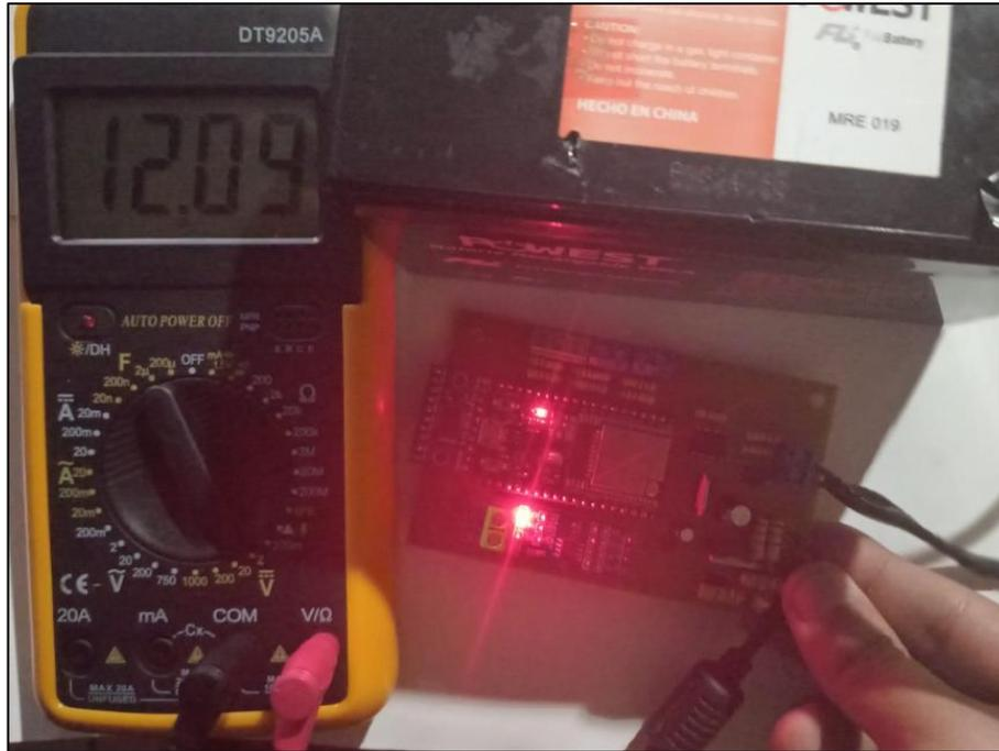
Ilustración 57. Pruebas de funcionamiento del circuito medidor de voltaje de la batería con un nivel de 12.09V.
