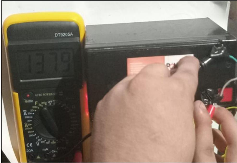
Ilustración 52. Medición de la tensión de entrada proporcionada por la fuente de respaldo.
