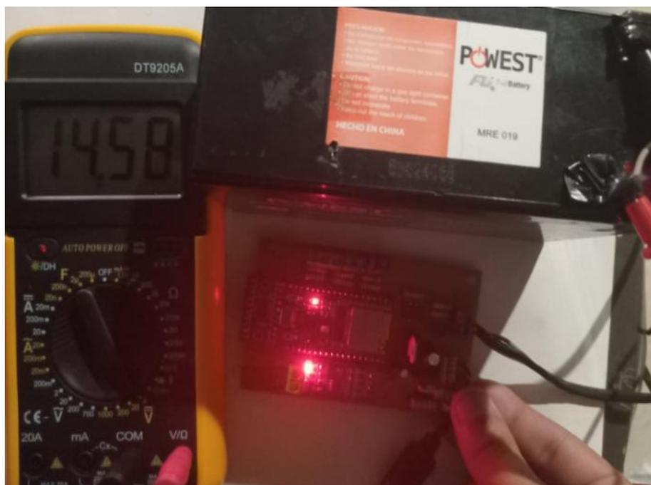
Ilustración 63. Pruebas de funcionamiento del circuito medidor de voltaje de la batería con un nivel de 14.58V.
