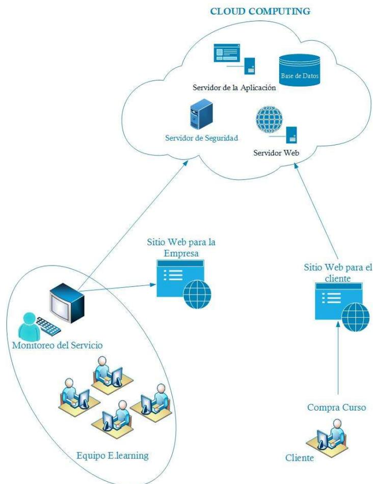
Figura 27 - Modelo de la Infraestructura requerida para el Proyecto
