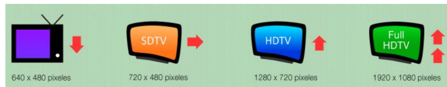
Figura 1.11: Resolución de la TV analógica vs la TV digital [4]
