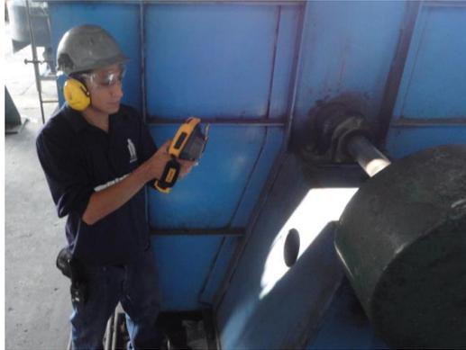
**FIGURA 4.3 CAPTURA DE IMÁGENES EN VENTILADOR DE HORNO.**
