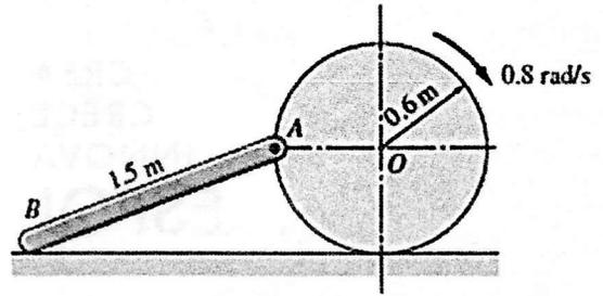
1.1 ¿Analizando únicamente el disco mostrado en la figura, explique y diagrame qué es un movimiento de rotación sin deslizamiento?
