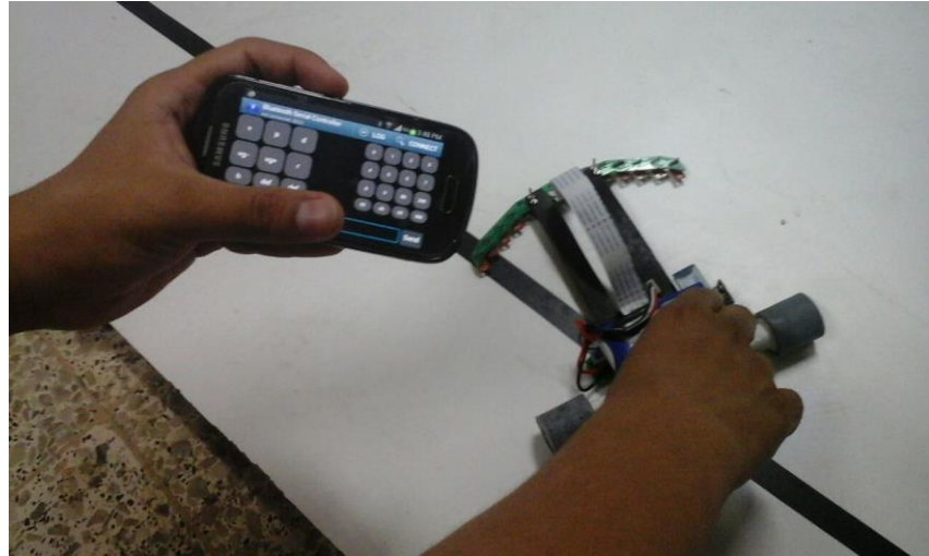
Figura 3.52 Ajuste de las constantes del Controlador de posición.
