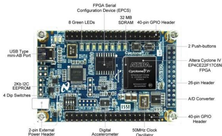
Figura 2.1 Tarjeta PCB y diagrama de componentes de la DE0-Nano (vista superior) [3]
