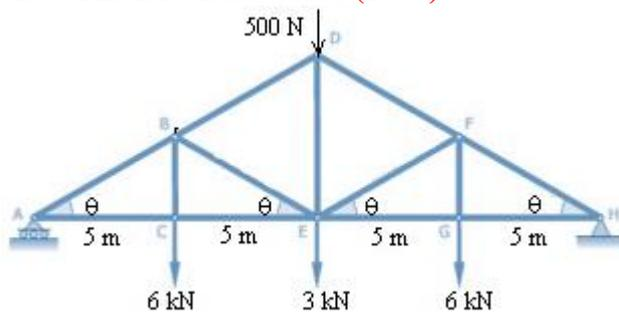
Una armadura Howe, se carga en la forma que muestra la figura.
