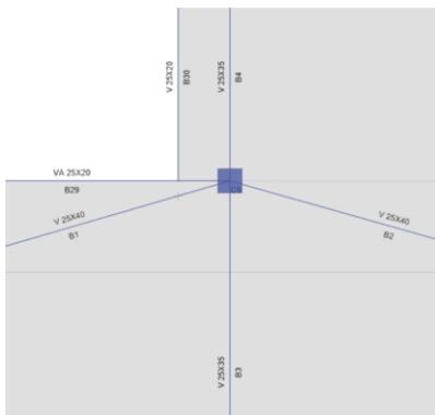
*Nota.* Para realizar este análisis, se considera la viga de tipo T, debido al aporte que proporciona la loseta de compresión de 5 [cm] de la losa nervada en dos direcciones de 20 [cm] que se considera en el diseño.
